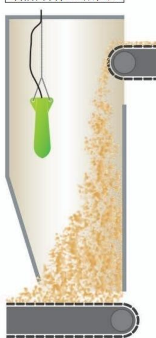
溜槽内料位上限検知
